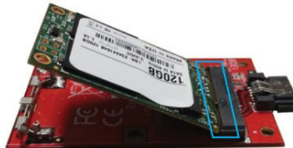
2. ドライブの上側中央をSSDクリップの両側にロックされるまで軽く押し下げます。SSDクリップからドライブを開放するには、クリップの両側に付いているレバーを使ってクリップ上部を引き上げます。
