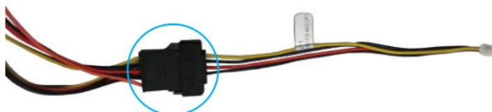
3. 付属のSATA電源の4ピン部分を4ピン電源アダプタを介してSAT32MSATMの4ピン電源コネクタに接続します。
