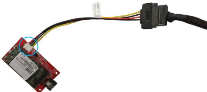
4. ドライブをインストールしたSAT32MSATMのSATAポートをシステムマザーボードの空きSATAポートに差し込みます。
